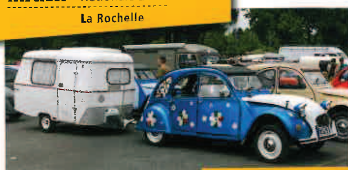
La caravane Eriba Puck que l'on peut tracter avec une 2 CV, rencontre un succès de plus en plus important... Pour plus de confort et de sécurité, cette 2 CV jaune est équipée d'un moteur 4 cylindres de GS !
