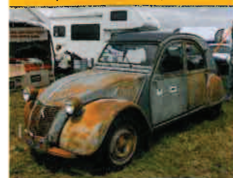
Dans la zone professionnelle, à côté du stand Burton, l'on pouvait découvrir cette AZLP de la fin des années 1950 mais équipée d'une mécanique moderne de 2 CV 6. On remarque que cette voiture revient certainement de très loin : les bas de caisse et les tôles d'auvent ont été changés et repeints. Il devait sans aucun doute s'agir d'une épave qui a été sauvée sous cette forme authentique mais à la mécanique plus récente.
